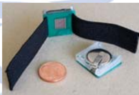
Obr. 4 - Bezdrôtový mikrosenzor na meranie impedance kože
